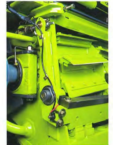
**Gegenschneideneinstellung:** Bei der Einstellung wird die Gegenschneide nicht gelöst, sondern der Amboss fährt mit fest verschraubter Gegenschneide feinfühlig an die Messertrommel heran.
