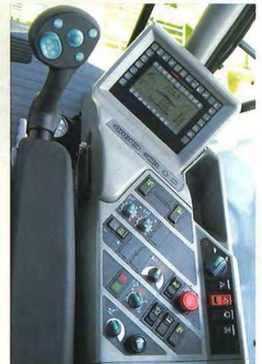
**Bedienpanel.** Rechts neben dem Fahrer, übersichtlich angeordnet das Bedienpanel für alle wichtigen Grundeinstellungen. Hier wird zum Beispiel der Messerschleifvorgang gestartet, die Gegenschneideneinstellung aktiviert.
