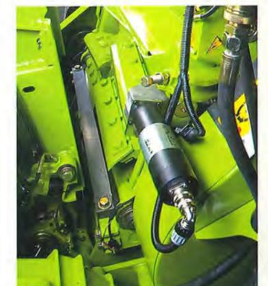
**Automatische Einstellung:** Ein Klopfsensor auf jeder Seite der Gegenschneide sichert die Einstellung auf Kontakt.
