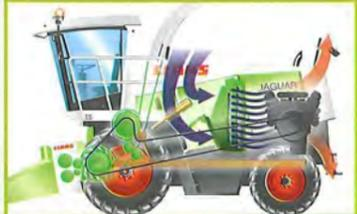
**Perfekt gekühlt:** Das neue Absaugsystem des großen Siebes die ideale Anordnung der Kühlung sichern reibungslose Arbeit mit höchster Durchsatzleistung.
