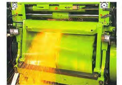
**Die Schleifvorrichtung:** Alles läuft automatisch ab. So ist das Messerschleifen während einer kurzen Arbeitspause eine Kleinigkeit.
