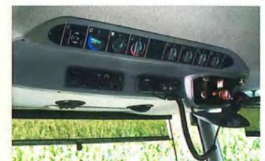
**Sinnvoller Komfort.** Eine gute Belüftung gehört wie eine Klimaanlage zum selbstverständlichen Lieferumfang eines JAGUAR. Der Einbau eines Radios und der einer Sprechfunkanlage sind vorinstalliert und im Kühlfach werden Getränke frisch gehalten.
