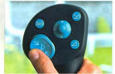
**Revolution bei der Kontrolle der Maschine:** Mit dem Multifunktionsgriff hat der Fahrer alle wichtigen Bedienfunktionen in seiner Hand. Fahrtrichtung, Fahrgeschwindigkeit, Krümmensteuerung, Vorsatzgerät heben und senken, sowie Reversieren des Einzugs sind hier optimal kombiniert.
