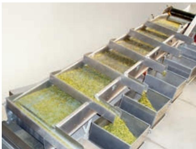
Si la longueur de coupe est réduite, le volume de particules fines dans le bac inférieur augmente. Selon le réglage de la longueur de coupe sur l'ensileuse, la proportion de chaque fraction tamisée varie. Il est important de noter qu'il s'agit toujours d'une longueur de coupe théorique pour la répartition des longueurs de coupe. Même si le produit ensilé est coupé avec précision, la répartition des fractions tamisées se définit toujours selon la courbe de Gauss.
