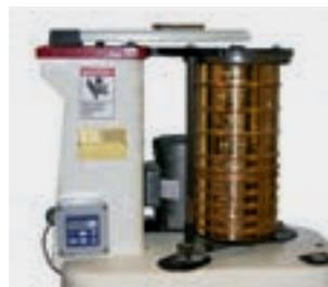
Analyse de l'ensilage avec le « Ro-Tap Shaker » (crible de triage) de l'entreprise Dairyland Laboratories, Inc.
